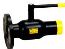
Кран шаровой серии 60 Фланец/Сварка Рабочее давление 25 бар Температура до -40/+200°C Присоединение под фланец/сварка
