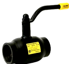
Кран шаровой серии 60 Резьба/Резьба Рабочее давление 40 бар Температура до -40/+200°C Присоединение под резьба/резьба
