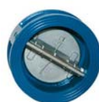
Двухстворчатый межфланцевый обратный клапан Рабочее давление 16 бар Температура до 110°C
