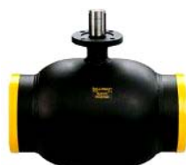
Кран шаровой серии 61 Сварка/Сварка с ИСО фланцем под редуктор Рабочее давление 25 бар Температура до -40/+200°C Присоединение под сварка/сварка
