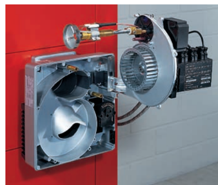
Для чистки вентиляторного колеса и корпуса горелка просто подвешивается на навесном устройстве
